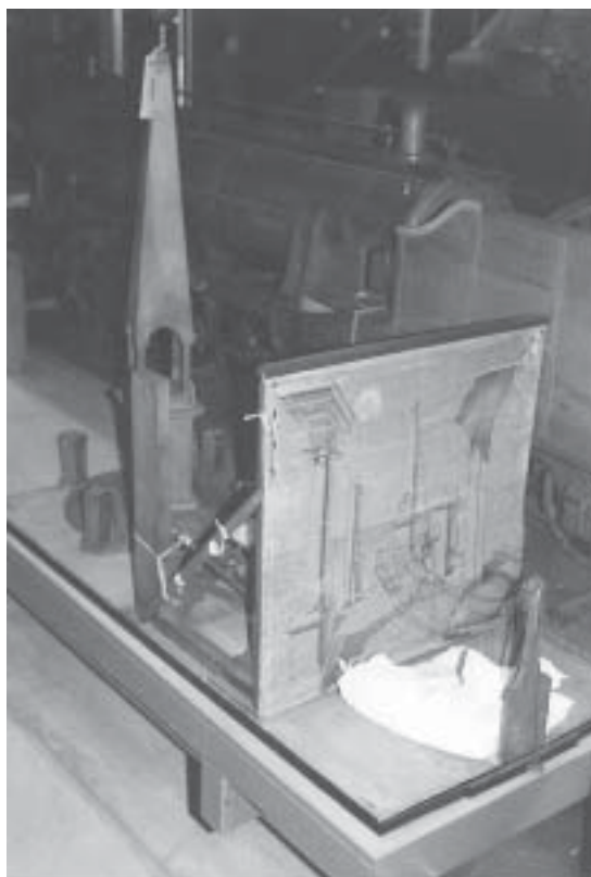
Figur 2 Instrument (defekt) til demonstration af en centralprojektion , Musée des Arts et Métiers, Paris.
